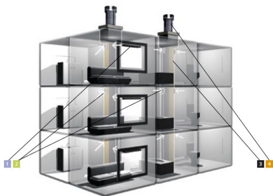
1 Nawiewniki powietrza 2 Kratki wywiewne 3 Przewody wentylacyjne 4 Nasada wentylacyjna niskociśnieniowa
